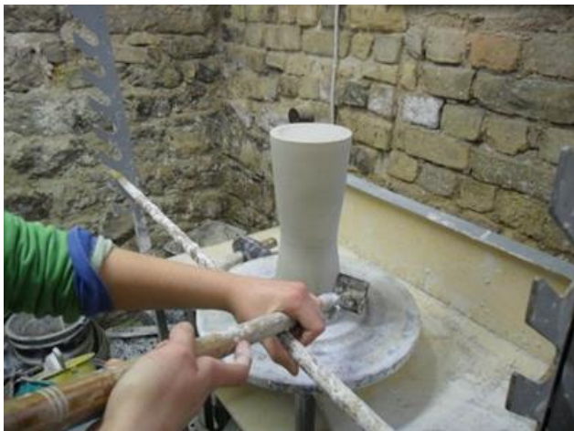
3.1.att. Lielās krūzes ģipša modeļa virpošana. 3.2.att. Mazās krūzes ģipša modeļa virpošana
