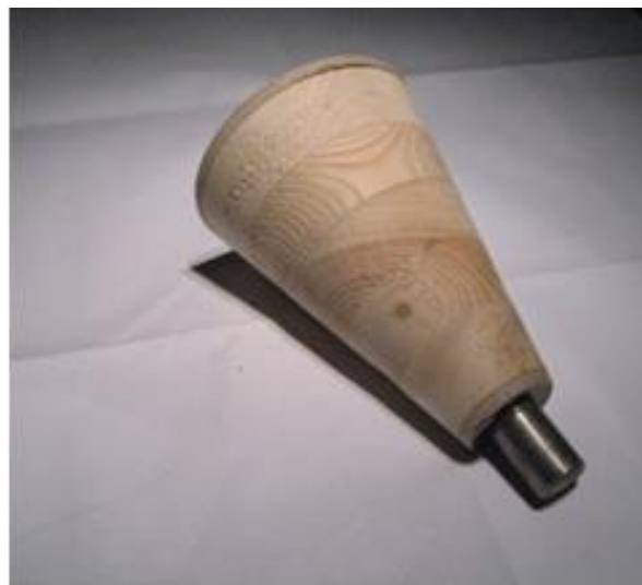
3.3.att.. Virpota koka forma - modelis lampas abažūra izgatavošanai.
