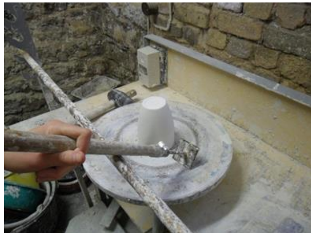
3.1.att. Lielās krūzes ģipša modeļa virpošana. 3.2.att. Mazās krūzes ģipša modeļa virpošana
